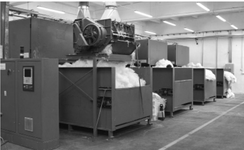
Płatki będące produktem recyklingu butelek PET wysyłane są do zakładu w Bielsku-Białej, gdzie są przetwarzane na runo. Część wraca do zakładu w Łęczycy, gdzie jest przetwarzana na różnego rodzaju włókniny.
