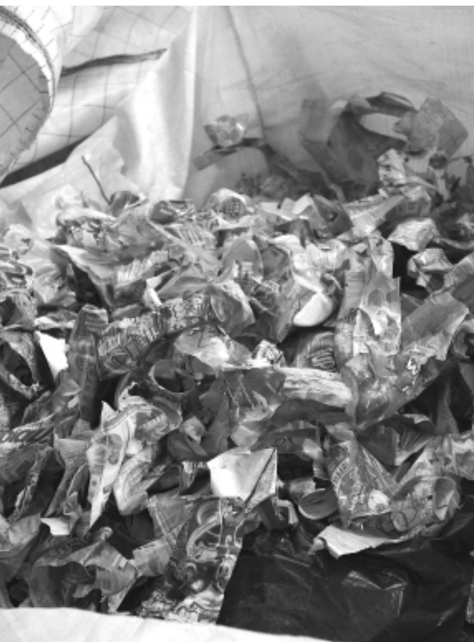
Największym problemem technicznym jest stosowanie przez niektórych producentów napojów naklejek wykonanych z termokurczliwej folii wykonanej z PCV.
