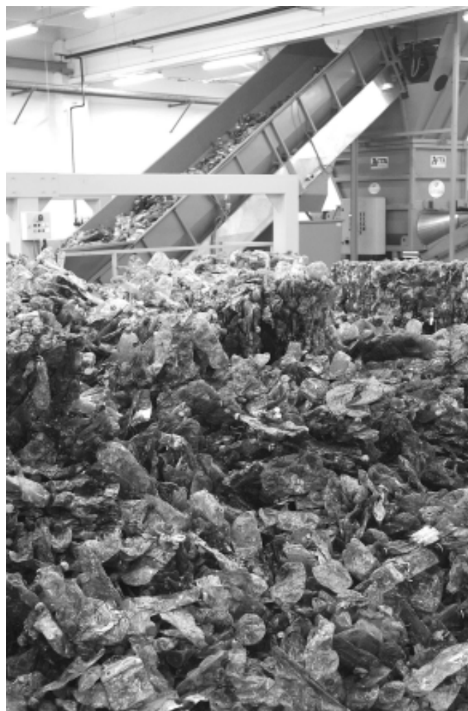
Spraszane butelki PET po rozpakowaniu wprowadzane są na linię do recyklingu.
