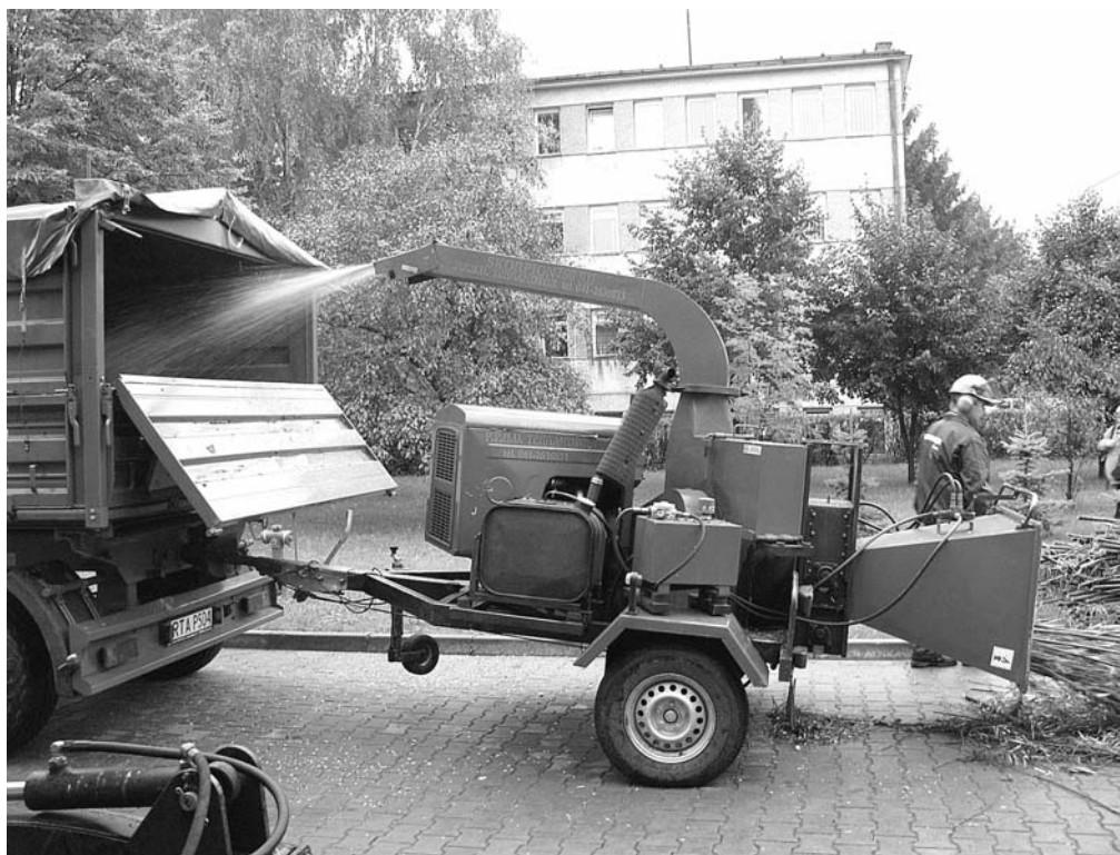
Własna baza paliwowa pozwala na przetwarzanie zarówno wierzby, jak i odpadów drzewnych na przydatne w kotłowni zrębki. Na fotografii zastaw samochodu ciężarowego z połową rębarką pozwalają na ekonomiczny transport paliwa z plantacji do miejsca składowania.
