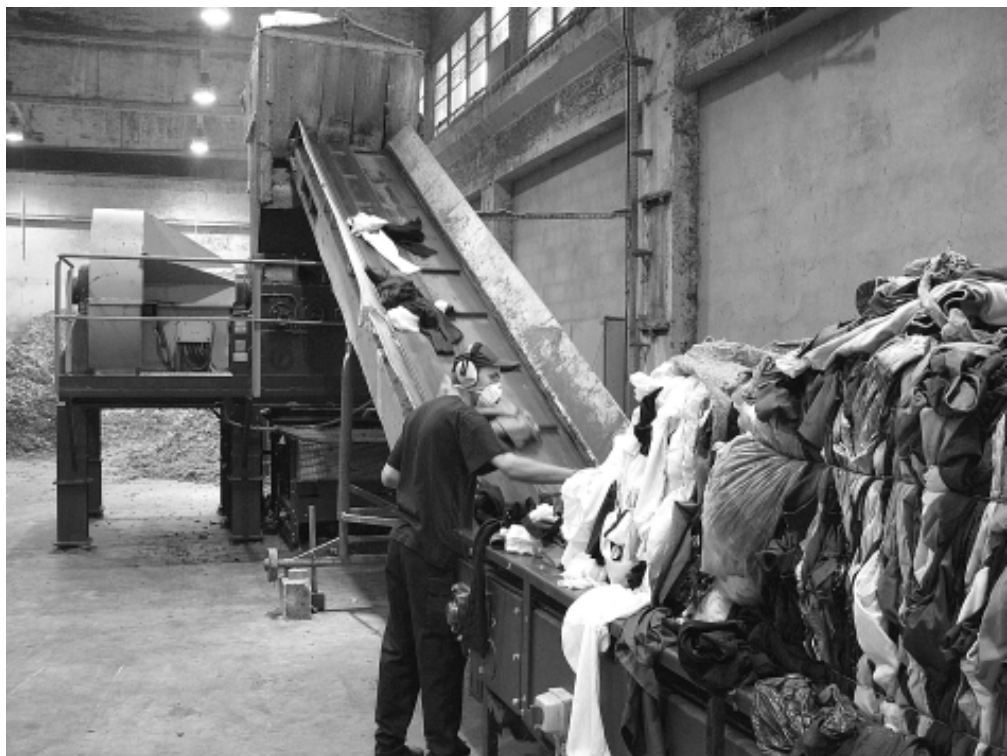
Bele z używaną odzieżą rozdrabnianą jako składnik paliwa alternatywnego w Zakładzie Segregacji i Odzysku Odpadów ALMAX w Skarżysku-Kamiennej.
