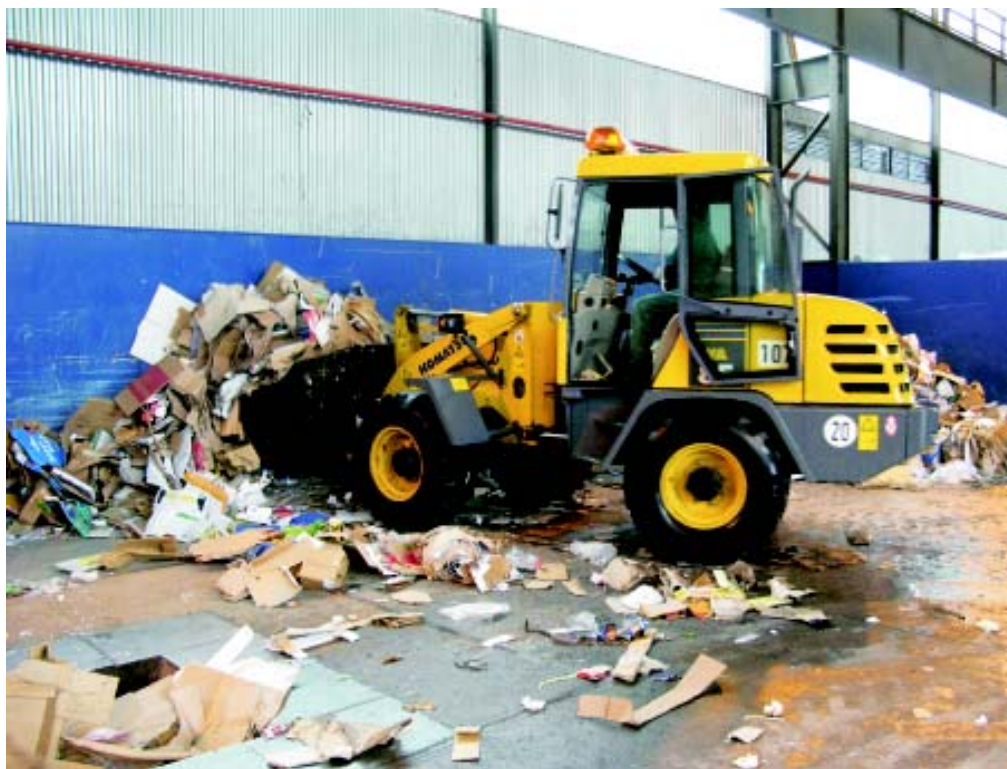
Sucha frakcja (makulatura i kartony) zasypywana jest do podajnika maszyny rozdrabniającej do produkcji paliwa alternatywnego w KOM-EKO w Lublinie.
